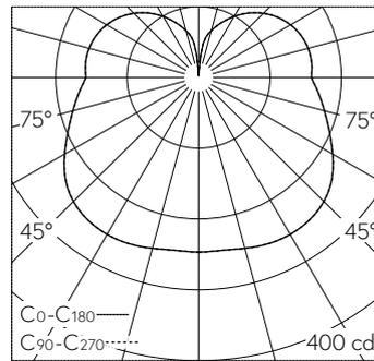
LED 3000 K 19.8 W 2199 lm-h / CIE Flux 30 57 80 61 100 / B21 nach DIN 5040
