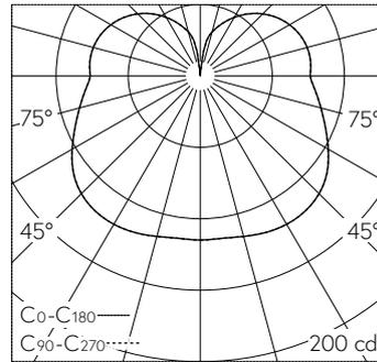
LED 3000 K 10.6 W 1046 lm-h / CIE Flux 29 57 79 61 100 / B21 nach DIN 5040
