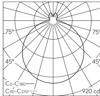
LED 3000 K 28.7 W 2711 lm-h / CIE Flux 45 75 92 86 100 / B43 nach DIN 5040
