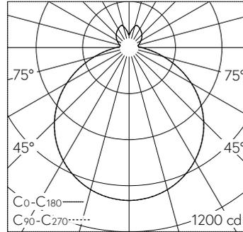
LED 3000 K 35 W 3640 lm-h / CIE Flux 45 75 92 84 100 / B43 nach DIN 5040
