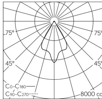
LED 3000 K 39.3 W 3415 lm-h / CIE Flux 91 94 98 98 100 / A80 nach DIN 5040
