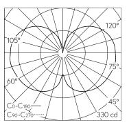
LED 4000 K 26 W 2806 lm-h / CIE Flux 22 47 72 54 100 / C11 nach DIN 5040
