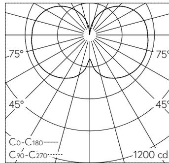
LED 3000 K 59,5 W 5920 lm-h / CIE Flux 22 47 73 55 100 / C11 nach DIN 5040
