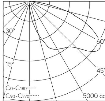
LED 3000 K 37 W 4615 lm-h / CIE Flux 30 67 94 100 100 / A20 nach DIN 5040
