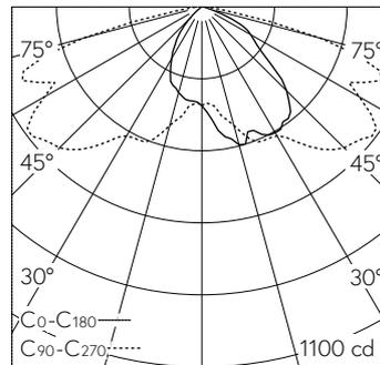
LED 3000 K 15.2 W 1593 lm-h / CIE Flux 38 75 96 100 100 / A30 nach DIN 5040
