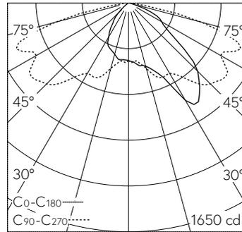
LED 4000 K 19 W 2359 lm-h / CIE Flux 36 74 96 100 100 / A30 nach DIN 5040
