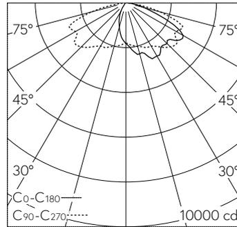
LED 3000 K 71 W 8963 lm-h / CIE Flux 32 66 92 100 100 / A20 nach DIN 5040
