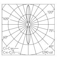
LED 3000 K 4.9 W 297 lm-h 19.8° / CIE Flux 99 100 100 50 100 / C84 nach DIN 5040
