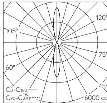
LED 3000 K 19 W 1434 lm-h 22° / CIE Flux 99 100 100 50 100 / C84 nach DIN 5040
