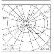
LED 3000 K 15.3 W 1325 lm-h / CIE Flux 14 38 67 50 100 / C11 nach DIN 5040
