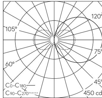
LED 2700 K 19,5 W 1649 lm-h / CIE Flux 14 38 67 50 100 / C11 nach DIN 5040
