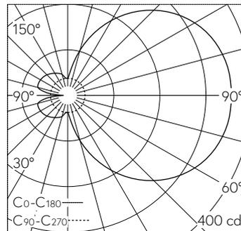
LED 3000 K 19.1 W 1539 lm-h / CIE Flux 17 42 69 50 100 / C11 nach DIN 5040
