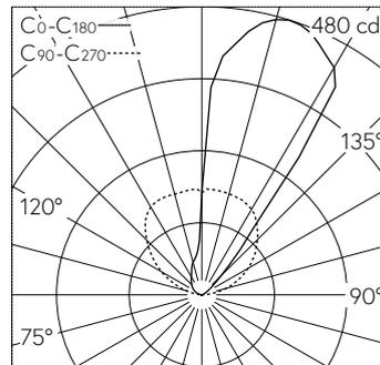
LED 4000 K 10.5 W 495 lm-h / CIE Flux 28 51 74 0 100 / E84 nach DIN 5040
