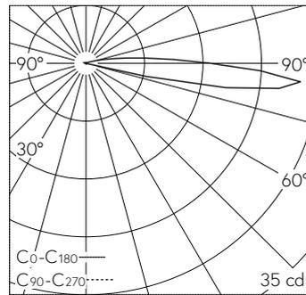
LED 2700 K 1.3 W 20 lm-h / CIE Flux 0 1 2 73 100 / B01 nach DIN 5040
