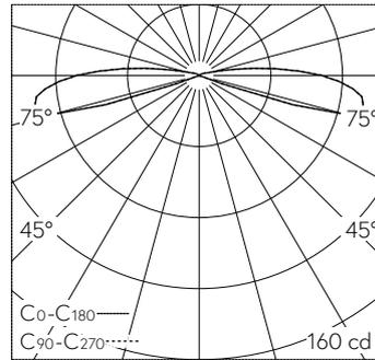
LED 3000 K 13.6 W 265 lm-h 176°/176° / CIE Flux 0 0 15 74 100 / B01 nach DIN 5040
