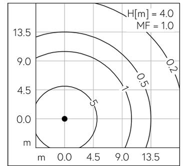
LED 4000 K 26.5 W 2874 lm-h H = 4 m / CIE Flux 20 46 73 69 100 / B11 nach DIN 5...
