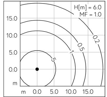
LED 3000 K 25.8 W 2635 lm-h H = 5 m / CIE Flux 34 63 84 84 100 / B21 nach DIN 5...
