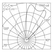
LED 4000 K 28 W 2164 lm-h / CIE Flux 0 7 40 0 100 / E84 nach DIN 5040
