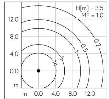
LED 3000 K 39.7 W 3131 lm-h H = 3.5 m / CIE Flux 41 74 93 92 100 / A31 nach DIN 5...
