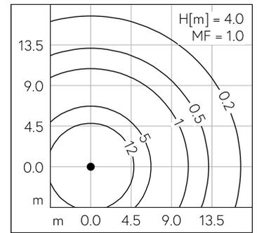
LED 3000 K 46.7 W 3841 lm-h H = 4 m/ CIE Flux 41 74 93 91 100 / A31 nach DIN 5040
