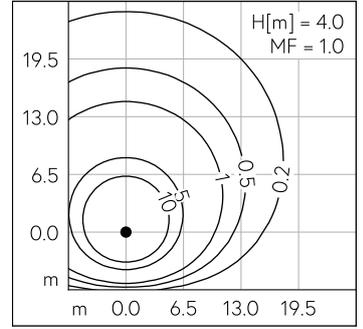
LED 4000 K 46.7 W 3961 lm-h H = 4 m / CIE Flux 41 74 93 91 100 / A31 nach DIN 5040
