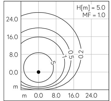
LED 4000 K 46.7 W 3768 lm-h H = 5 m / CIE Flux 41 74 93 91 100 / A31 nach DIN 50...
