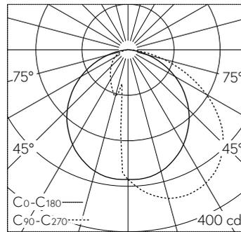
LED 3000 K 9.4 W 756 lm-h / CIE Flux 48 80 96 100 100 / A40 nach DIN 5040
