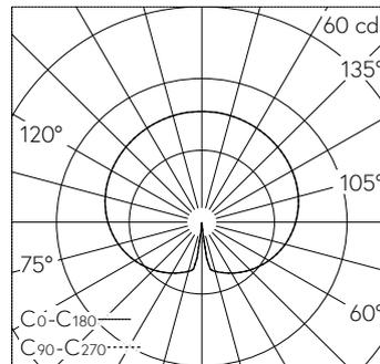
LED 3000 K 4.8 W 539 lm-h 312° / CIE Flux 19 43 69 42 100 / C12 nach DIN 5040
