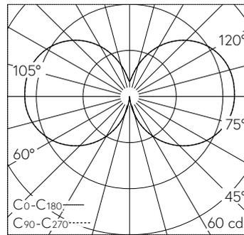
LED 3000 K 4.8 W 450 lm-h 180° / CIE Flux 13 38 66 48 100 / C11 nach DIN 5040
