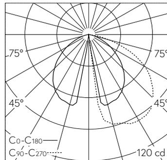
LED 3000 K 2.7 W 166 lm-h / CIE Flux 45 81 97 100 100 / A40 nach DIN 5040
