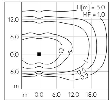
LED 4000 K 34.5 W 4882 lm-h H = 5 m / CIE Flux 38 75 96 100 100 / A30 nach DIN ...
