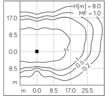
LED 4000 K 53 W 7770 lm-h H = 7 m / CIE Flux 33 72 98 100 100 / A20 nach DIN 5...
