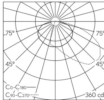
LED 4000 K 9.5 W 515 lm-h / CIE Flux 34 66 90 99 100 / A20 nach DIN 5040
