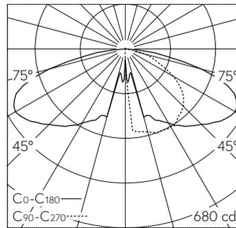
LED 3000 K 14 W 933 lm-h / CIE Flux 31 66 93 100 100 / A20 nach DIN 5040
