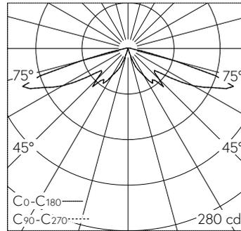
LED 3000 K 13.6 W 427 lm-h / CIE Flux 15 43 93 98 100 / A10 nach DIN 5040
