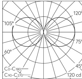
LED 3000 K 15 W 926 lm-h 222°/222° / CIE Flux 11 35 65 49 100 / C11 nach DIN 5040
