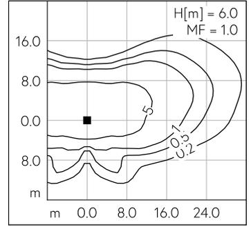
LED 3000 K 34 W 4645 lm-h H = 5 m / CIE Flux 35 69 94 100 100 / A30 nach DIN 5...
