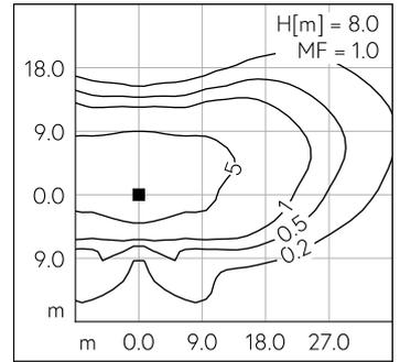
LED 3000 K 34 W 4645 lm-h H = 7 m / CIE Flux 35 69 94 100 100 / A30 nach DIN 5...
