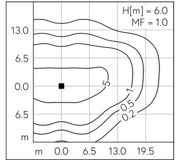
LED 3000 K 18.7 W 2297 lm-h H = 5 m / CIE Flux 29 67 96 100 100 / A20 nach DIN ...
