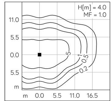
LED 3000 K 18.7 W 2297 lm-h H = 4 m / CIE Flux 29 67 96 100 100 / A20 nach DIN ...
