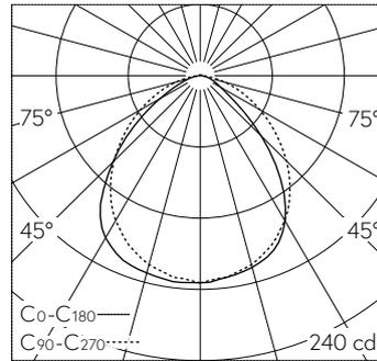
LED 3000 K 4.9 W 404 lm-h / CIE Flux 57 87 97 99 100 / A50 nach DIN 5040
