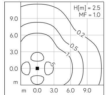
LED 3000 K 13.6 W 1004 lm-h H = 2.5 m / CIE Flux 12 39 67 57 100 / C11 nach DIN 5...
