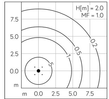
LED 3000 K 14.3 W 695 lm-h H = 2 m / CIE Flux 15 39 67 56 100 / C11 nach DIN 5040
