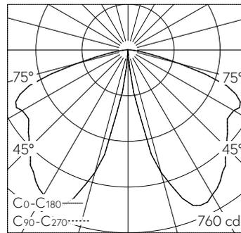
LED 3000 K 33 W 1804 lm-h / CIE Flux 38 70 95 99 100 / A30 nach DIN 5040
