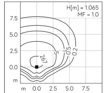
LED 3000 K 22 W 2627 lm-h / CIE Flux 40 81 98 100 100 / A30 nach DIN 5040
