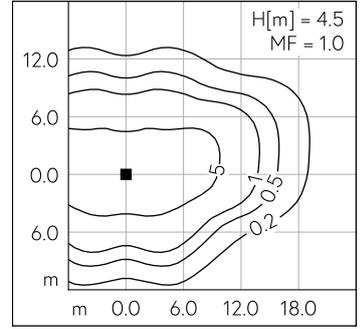
LED 3000 K 37.4 W 4594 lm-h H = 4 m / CIE Flux 29 67 96 100 100 / A20 nach DIN ...
