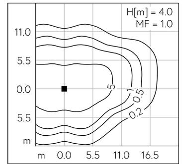
LED 4000 K 37.4 W 4734 lm-h H = 4 m / CIE Flux 29 67 96 100 100 / A20 nach DIN ...
