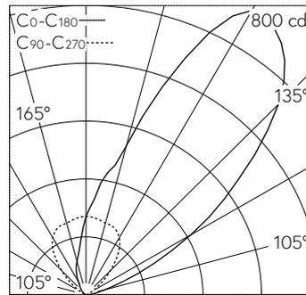
LED 2700 K 9.5 W 769 lm-h / CIE Flux 0 0 0 100 / E84 nach DIN 5040
