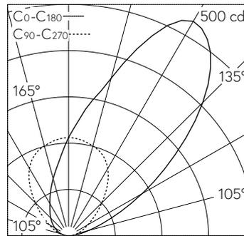
LED 2700 K 9.5 W 769 lm-h / CIE Flux 0 0 0 100 / E83 nach DIN 5040
