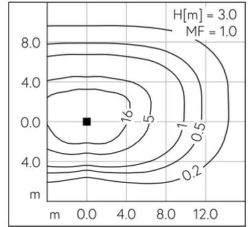
LED 4000 K 31 W 4218 lm-h H = 2.5 m / CIE Flux 41 77 96 100 100 / A30 nach DIN 5...
