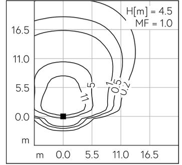
LED 3000 K 29.2 W 4019 lm-h H = 4 m / CIE Flux 32 65 94 100 100 / A20 nach DIN ...
