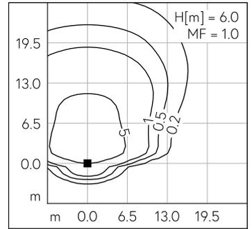
LED 3000 K 29.2 W 4019 lm-h H = 5 m / CIE Flux 32 65 94 100 100 / A20 nach DIN ...
