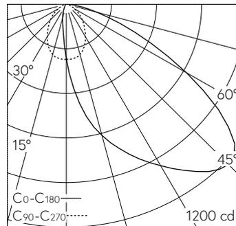
LED 3000 K 13 W 1332 lm-h / CIE Flux 44 83 98 100 100 / A40 nach DIN 5040
