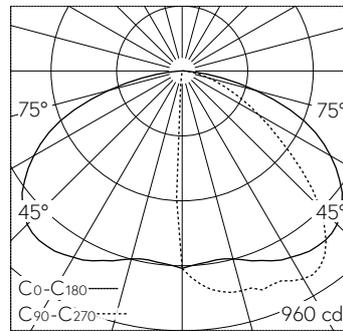
LED 4000 K 18 W 1931 lm-h / CIE Flux 42 77 96 100 100 / A30 nach DIN 5040
